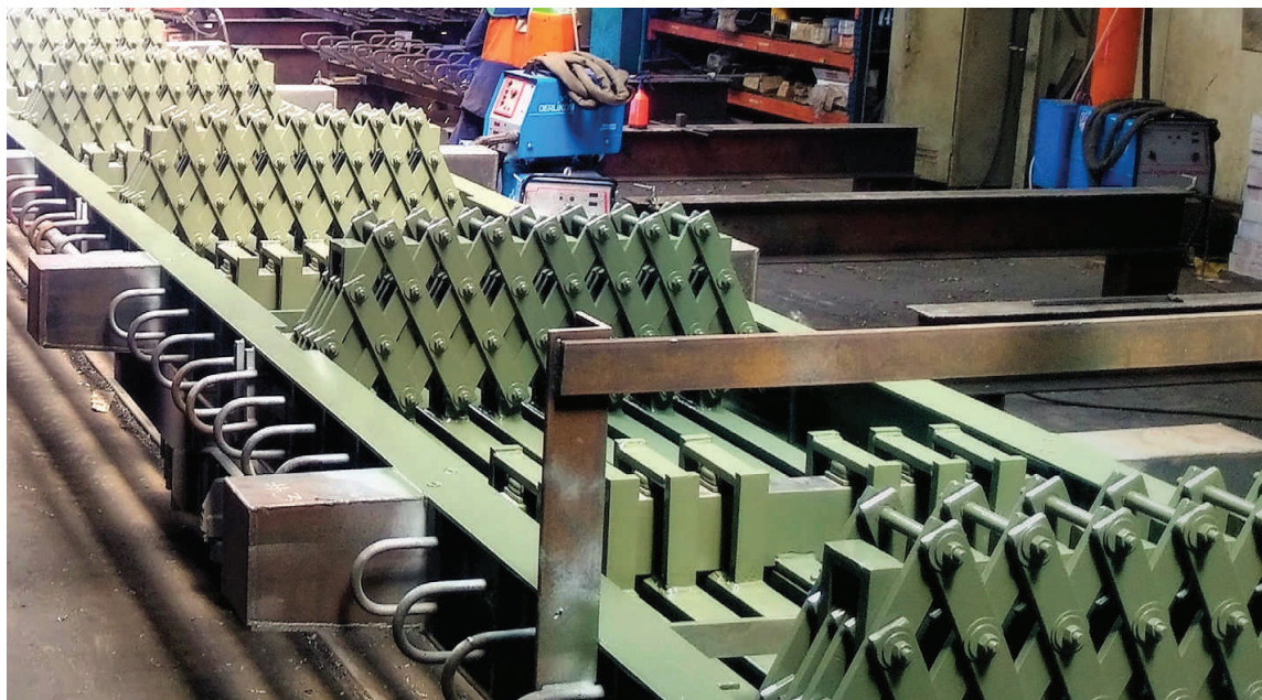
Viacmodulové dilatačné závery v sebe spájajú výhody nosníkového a nožnicového podporného systému do jedného komplexného systému.
